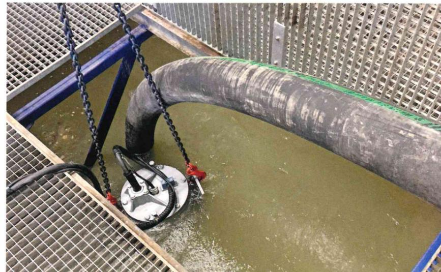
Das unterirdische Prüfbecken verfügt über induktive Durchflussmesser und eine elektrische Prüfanlage zur Durchführung der wiederkehrenden Geräteprüfung nach ÖVE E8701.
